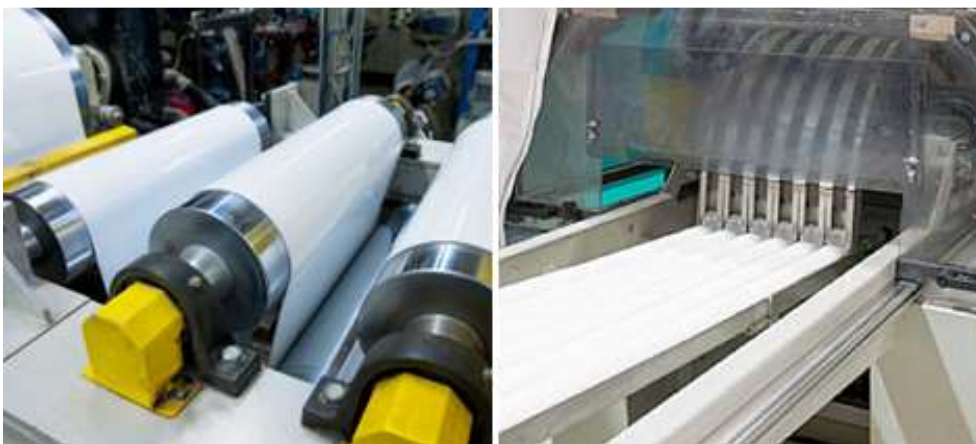
Obr. 9: Extruze fólie a tvarování ve firmě greiner packaging slušovice s.r.o. (31)
