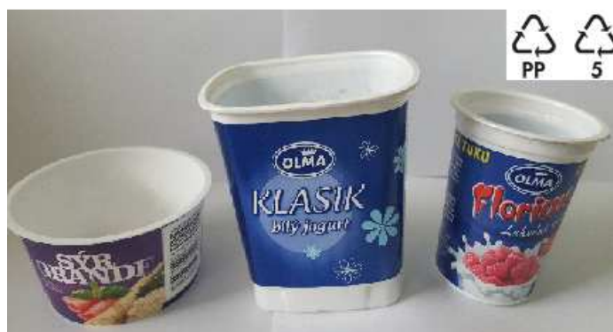
Obr. 2: Obaly vyrobené z polypropylenu a jejich recyklační značky (foto: autor)
