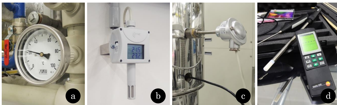
obr. 5–25: Měření teploty a vlhkosti: (a) mechanický teploměr, (b) kombinované čidlo prostorové teploty a rel. vlhkosti s převodníkem, (c) hlavicevý teploměr s platinovým teplotním čidlem a komb. kabelová sonda teploty a rel. vlhkosti, (d) mobilní měřicí sestava pro měření teploty a vlhkosti
