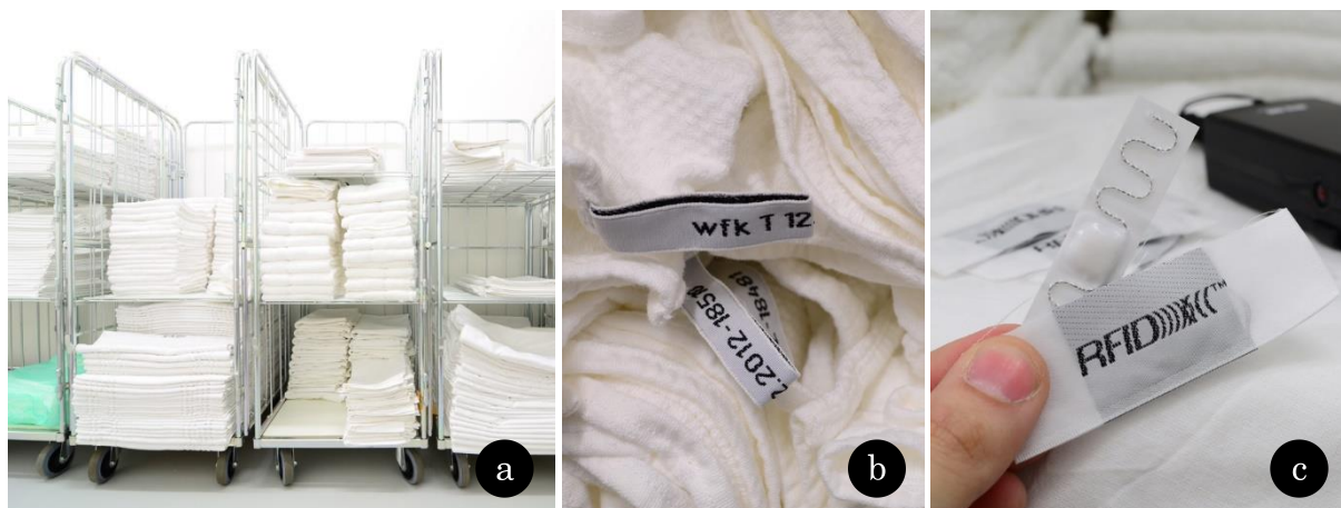
obr. 5–9: Běžné testovací prádlo (a), certifikované testovací prádlo WFK (b), RFID UHF transpondér v textilní kapsičce pro našití na prádlo (c)
