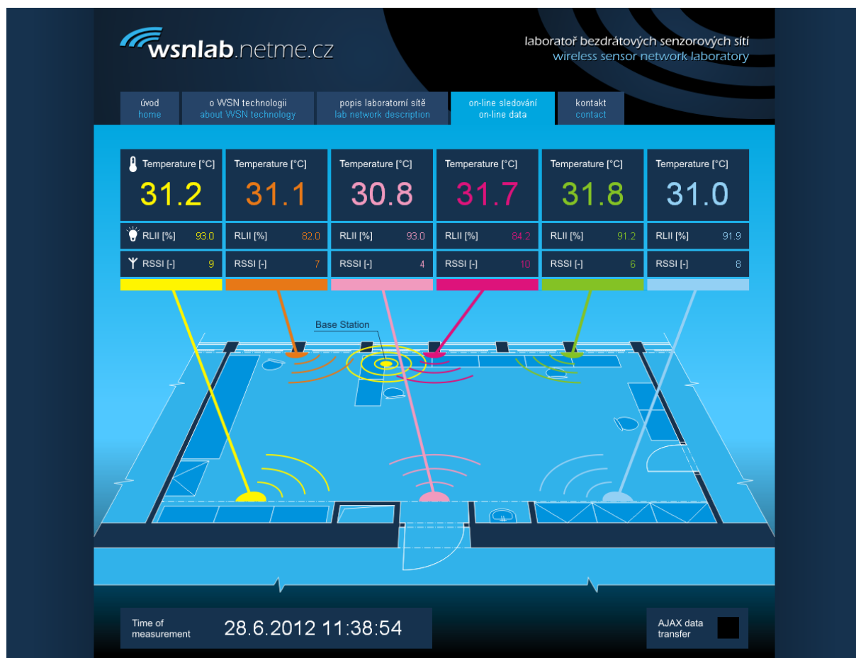
obr. 4–5: Snímek internetových stránek projektu WSN Lab, které umožňovaly online sledovat měřené hodnoty okolní teploty, intenzity osvětlení a síly signálu jednotlivých uzlů (provoz ukončen)
