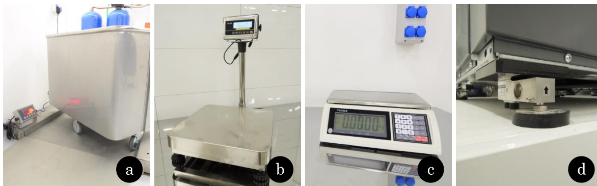
obr. 5–24: Měření hmotnosti: (a) plošinová váha s nájezdy, (b) můstková váha, (c) přesná váha, (d) vážící tenzometrické buňky v základně stroje
