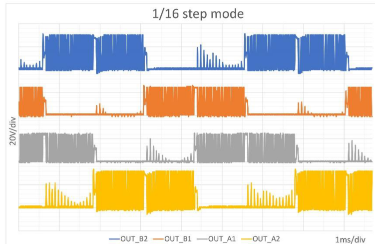
Obrázek 6-9 Napětí na cívkách motoru při běhu s mikrokrokováním
