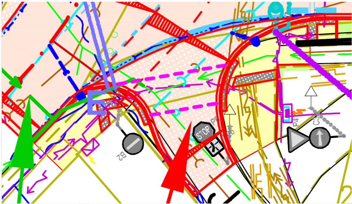
Obrázek 6.9 Chybějící osvětlení místa pro přecházení ulice Janáčkova (DSP)
