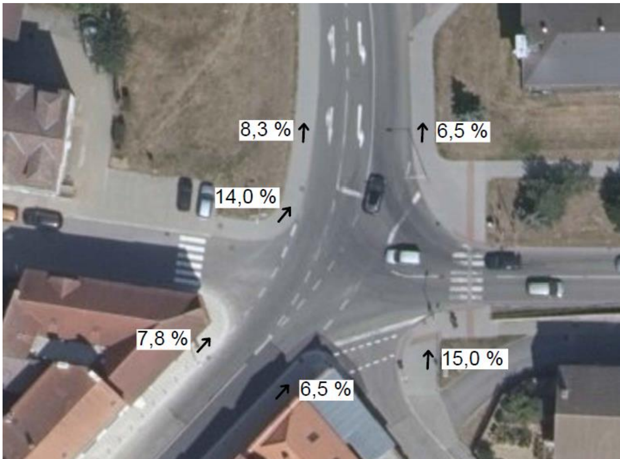
Obrázek 8.4 Zjištěné podélné sklony chodníků (podklad www.cuzk.cz )
