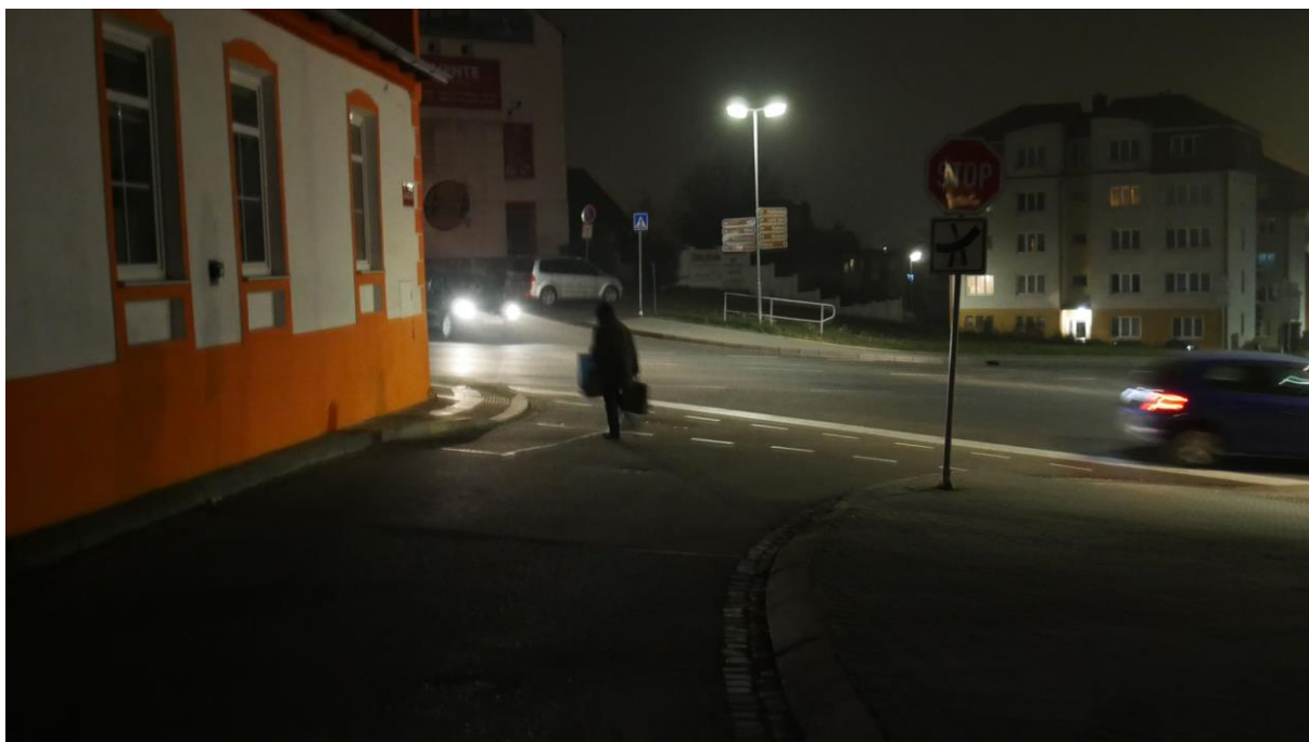
Obrázek 8.23 Chybějící osvětlení místa pro přecházení ulice Janáčkova
