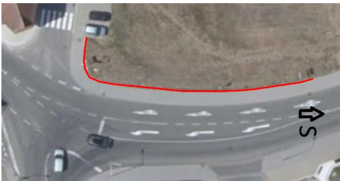
Obrázek 8.28 Nedostatečné převýšení obrubníku trávníku
