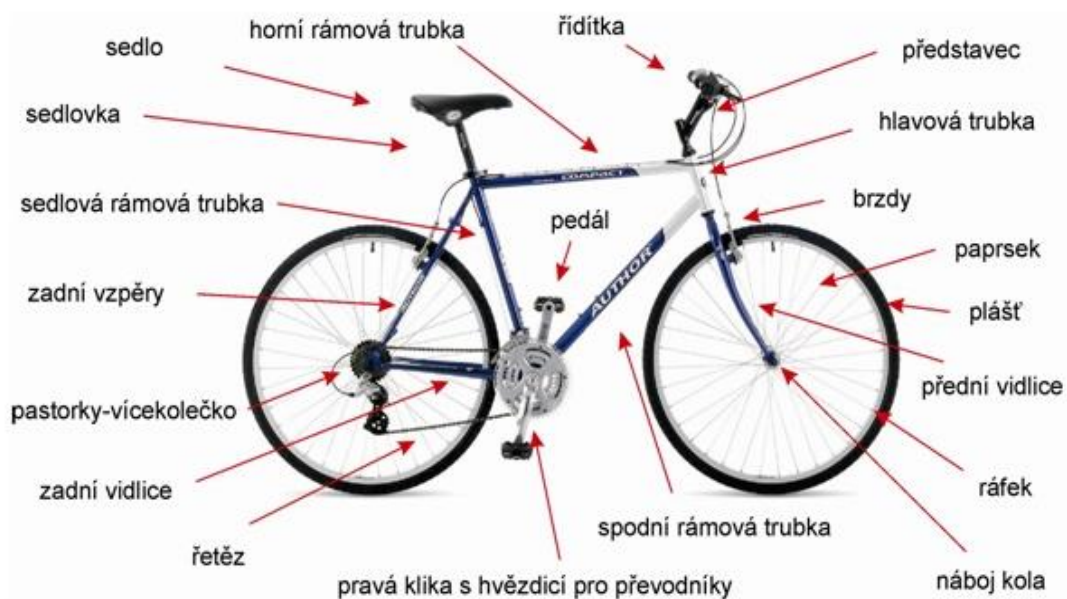
Obrázek 4. Anatomie jízdního kola (Baláš a kol., 2013)
