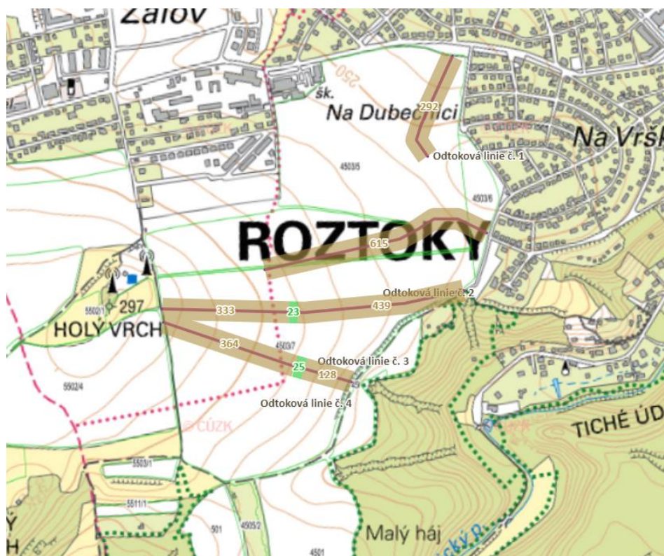
Obrázek 26 Návrh opatření travního pásu (VUMOP)
