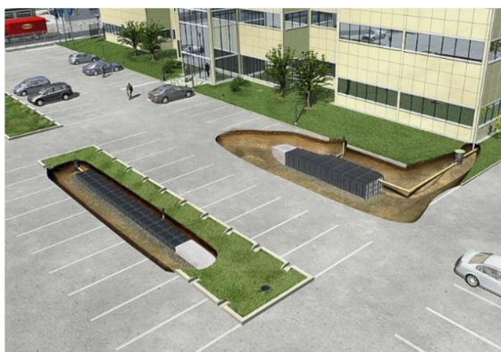
Obrázek 10 Vsakovací blok (Eco Aqua shop, 2023)
