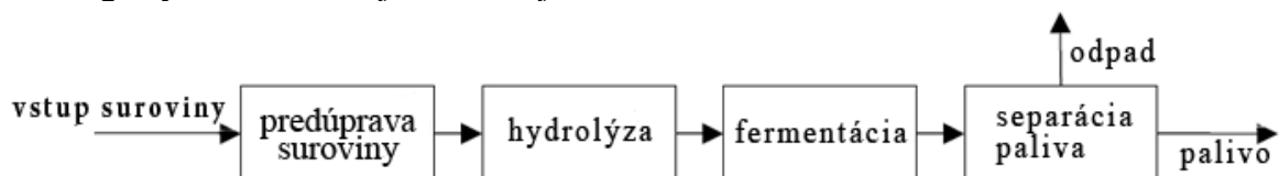
Obr. č. 8: Proces výroby bioetanolu [54]
