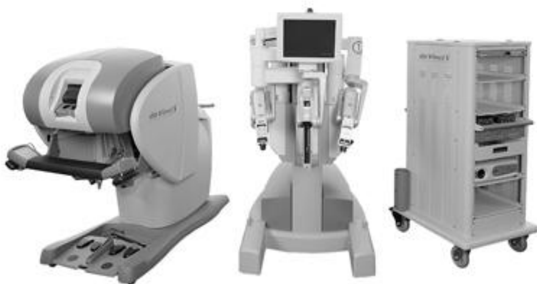
Obrázek 2 Sestava Da Vinci konzole, operační robot, řídicí jednotka (zleva) [8]
