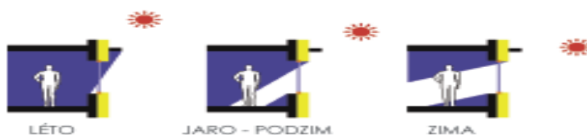
Obrázek 13: Ochranu proti přehřívání interiéru zabezpečuje stínění, ( http://www.pasivnidomy.cz/data/stineni.jpg , 2013)
