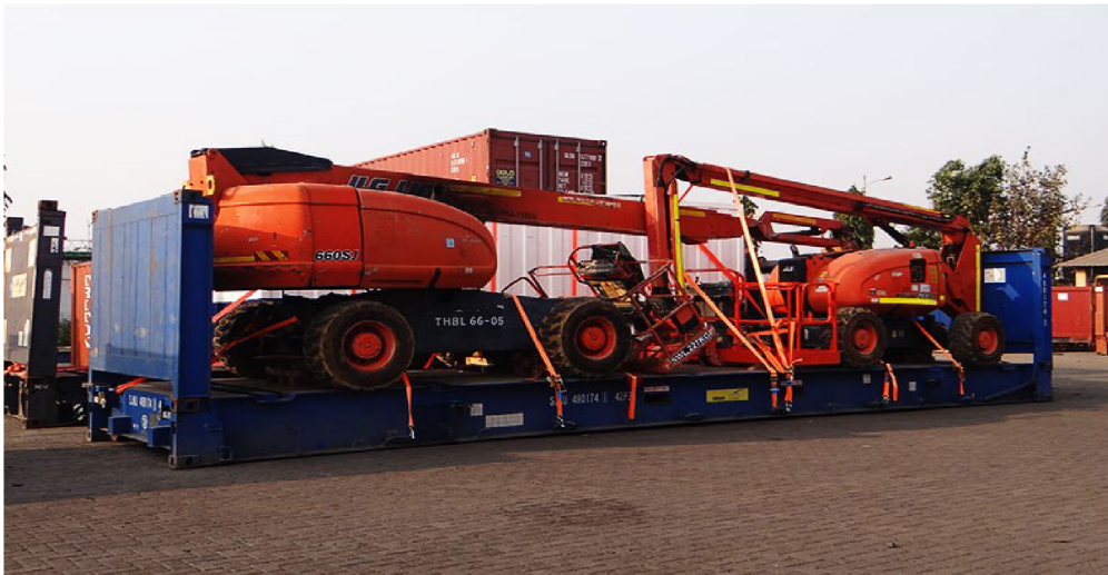
Obr. 1.6 Plochý 40“ Rack so sklopnými koncami Zdroj: [26].
