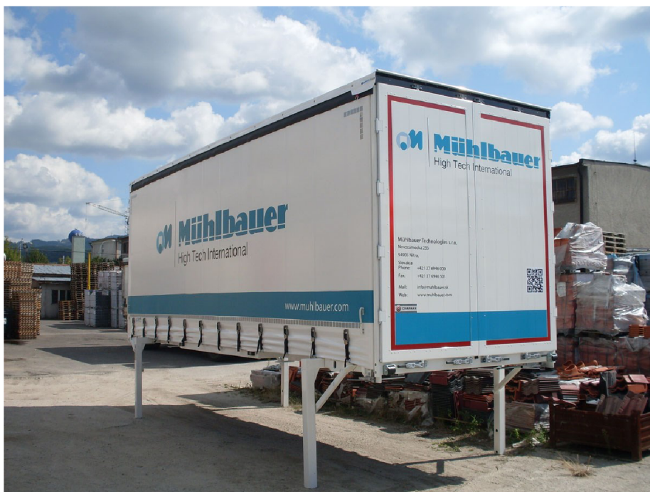
Obr. 1.10 Výmenná nadstavba Zdroj: [28].
