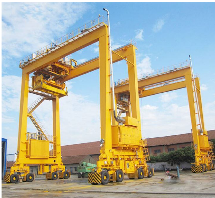
Obr. 1.11 Mobilný kontajnerový žeriav RTG s gumenými pneumatikami Zdroj: [9].
