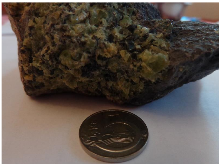
Foto 2: Lom Proseč, Vzorek č. 1 - Detail zelených vyrostlic olivínu a tmavých vyrostlic pyroxenu, (foto autor)
