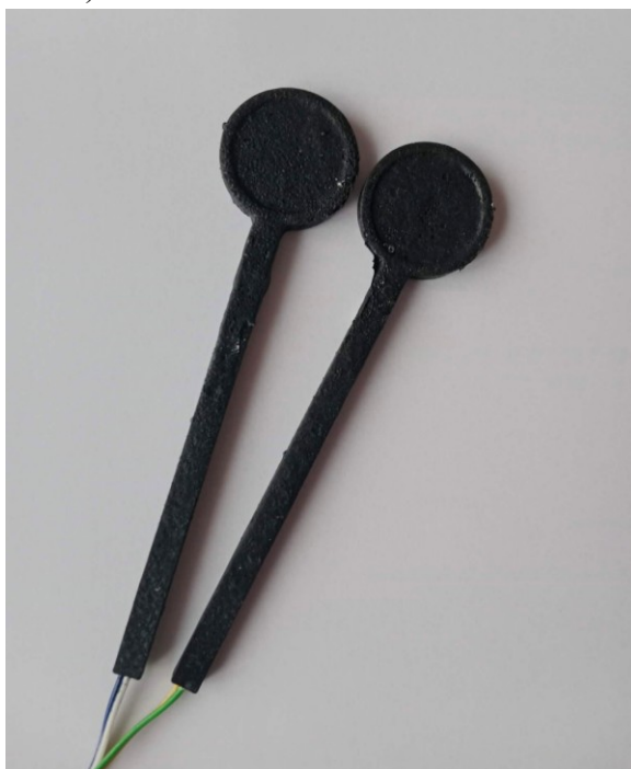
Obrázek 7: Hydrofony – povrchová úprava gumou ve spreji
