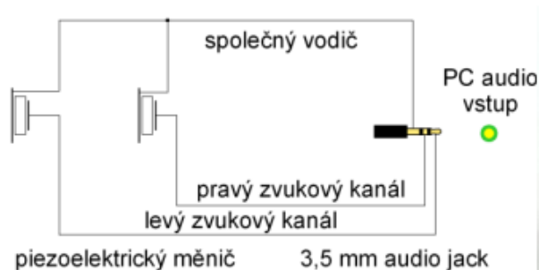
Obrázek 6: Schéma zapojení piezoelektrických měničů ke konektoru [25]
