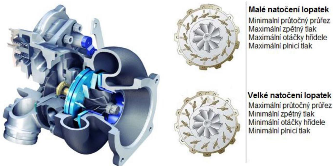
Obr. 3.4. Konstrukce VNT technologie a natočení lopatek. [13].
