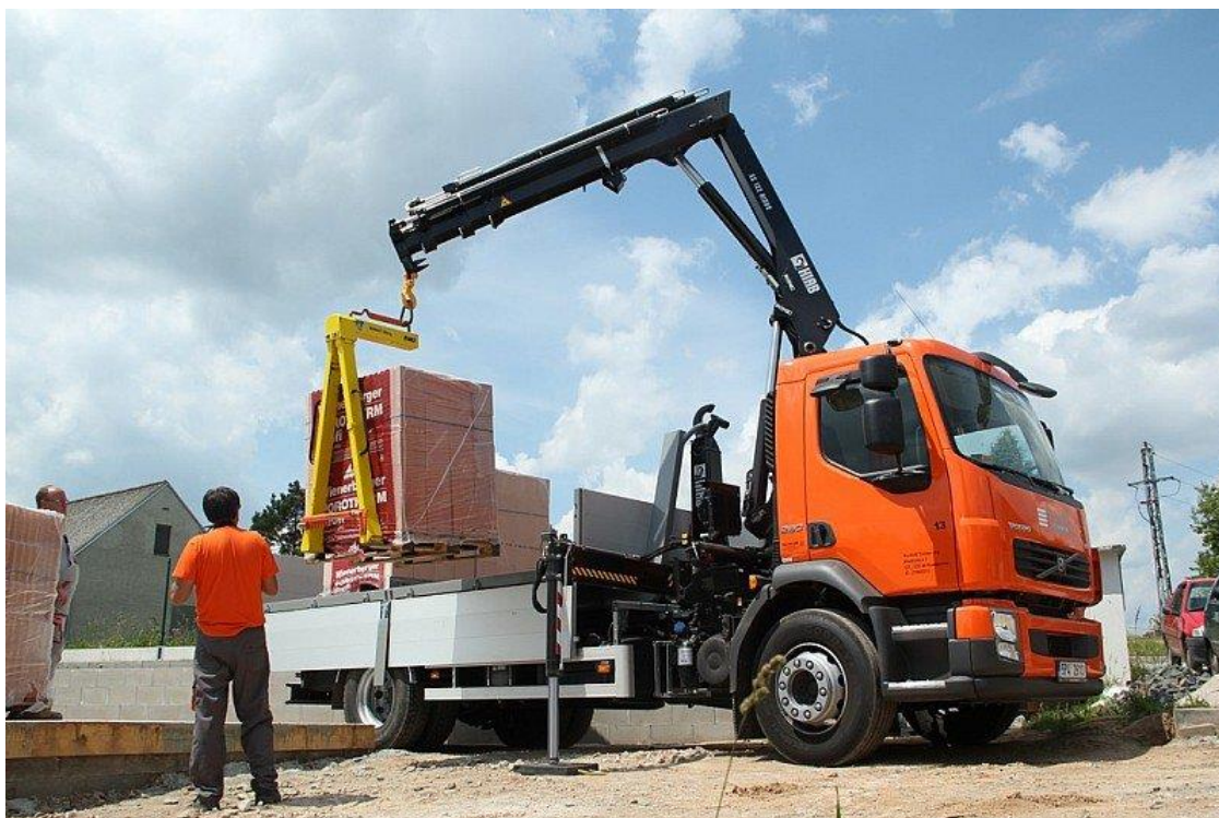
Obrázek 60 - Valník s hydraulickou rukou: Volvo FLH 260 HP 4x2 [26]
