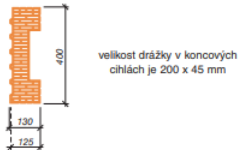
Obrázek 21 – Rozměry Porothermu 40 Profil ½ (poloviční koncová) [2]
