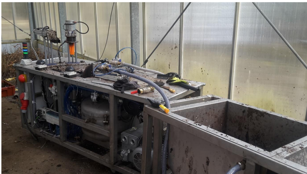
Obrázek 1: Prototyp stroje na obalování sadebního materiálu technologií PostCont. Ze zásobovačů na papírovinu a substrát (v pravé části obrázku) tyto materiály proudí hadicemi do pracovního prostoru. Zde je do formy nejprve vstříknuta papírovina, která je rozmetačem rozmetena na stěny. Následně je do formy podavačem vložena sazenice s předem zkrácenými kořeny a zalita substrátem. Hotový kelímek je vystrčen na povrch a připraven k odejmutí.
