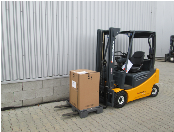
Obr. 10: Čtyřkolový vysokozdvizný vozík Jungheinrich EFG 216k SP450DZ
