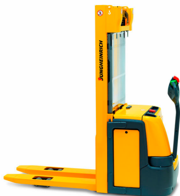
Obr. 11: Ručně vedený vozík Jungheinrich ERC 216 280 Z
