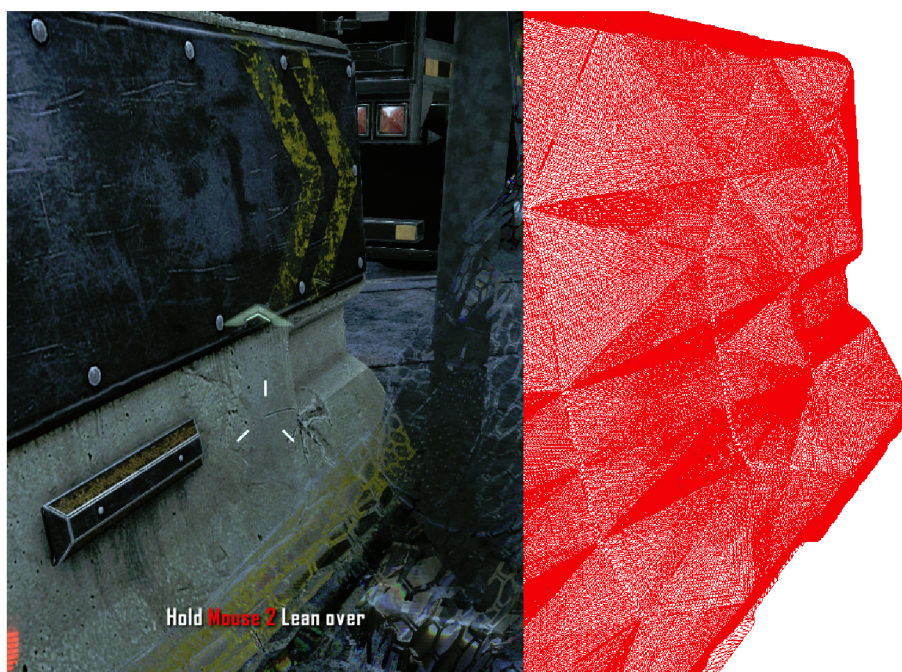
Obrázek 10.2: Crysis 2 - ukázka zbytečně teselovaných oblastí modelu. zdroj: [14]
