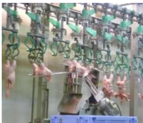
Obr. 12.6 Stroj na odřezávání křídel
