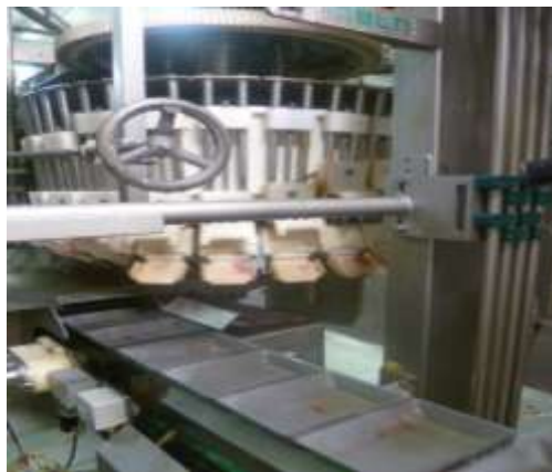
Obr. 12.4 Karuselový a miskový dopravník
