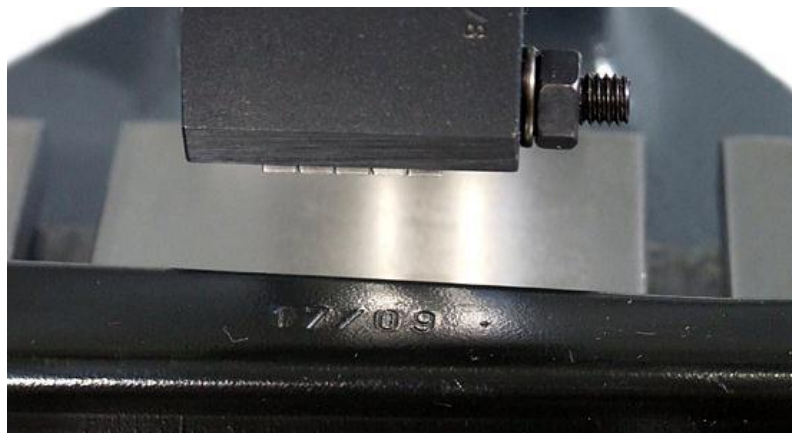
Obrázek 8: Ražba sériového čísla [8]
