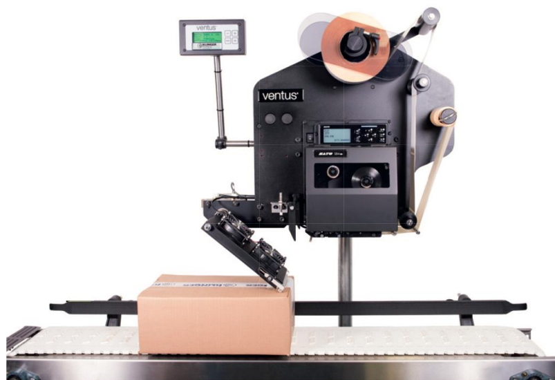
Obrázek 23: Automatický aplikátor etiket s tiskem VENTUS 920VL [20]
