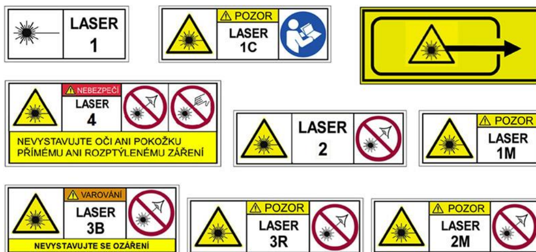
Obrázek 19: Alternativní výstražné štítky pro laserová zařízení [4]
