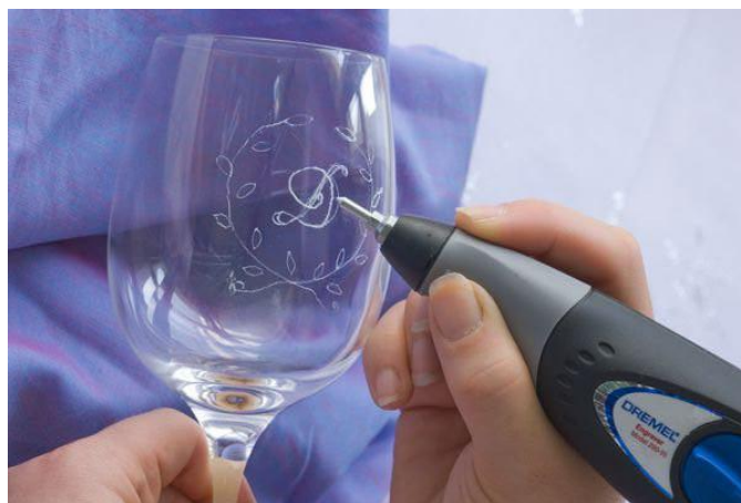
Obrázek 9: Gravírování skla ruční pistolí [10]
