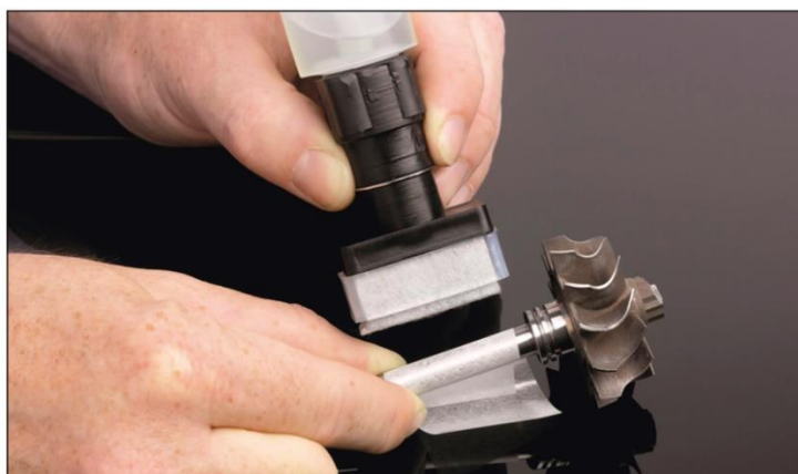
Obrázek 24: Ruční elektrochemické značení [22]
