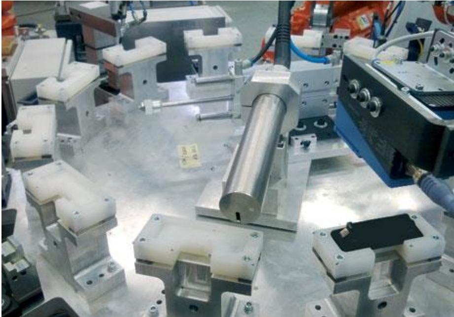
Obrázek 21: Značení komponent technologií InkJet na otočném stole [19]
