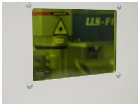
Obrázek 64: Bezpečnostní minerální sklo od firmy Lintech [56]
