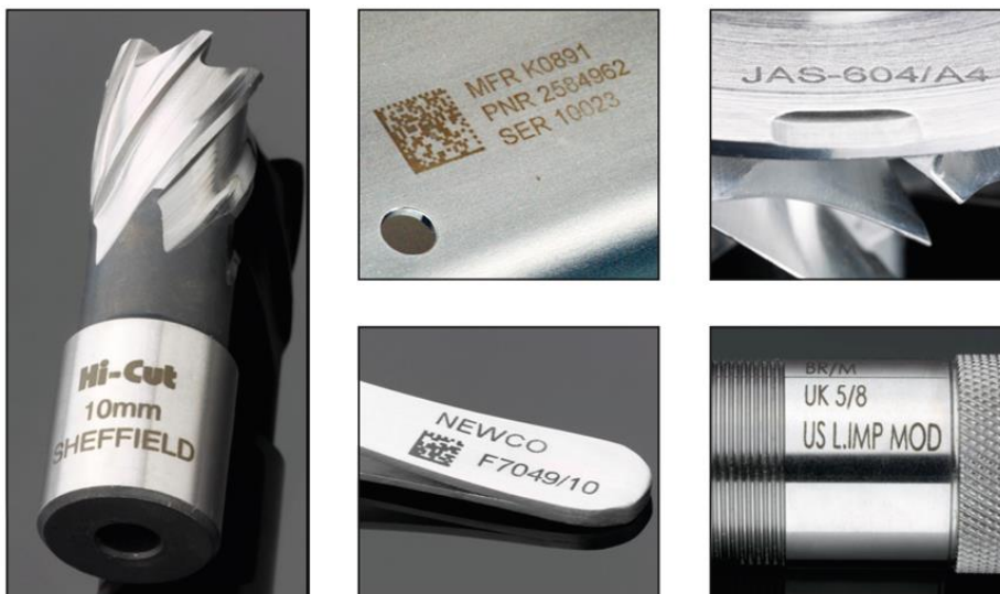
Obrázek 25: Příklady využití elektrochemického značení [22]
