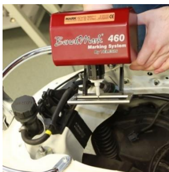
Obrázek 5: Značení VIN kódu pomocí ruční mikroúderové jednotky [6]
