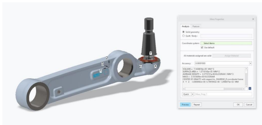
Obrázek 37: Výpočet váhy a těžiště ramene [Zdroj: vlastní]
