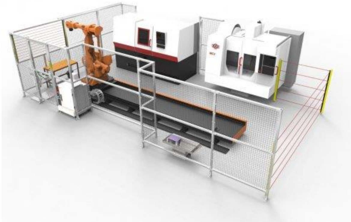
Obrázek 26: Digitální dvojče výrobní buňky vytvořené na ÚVSSR [26]
