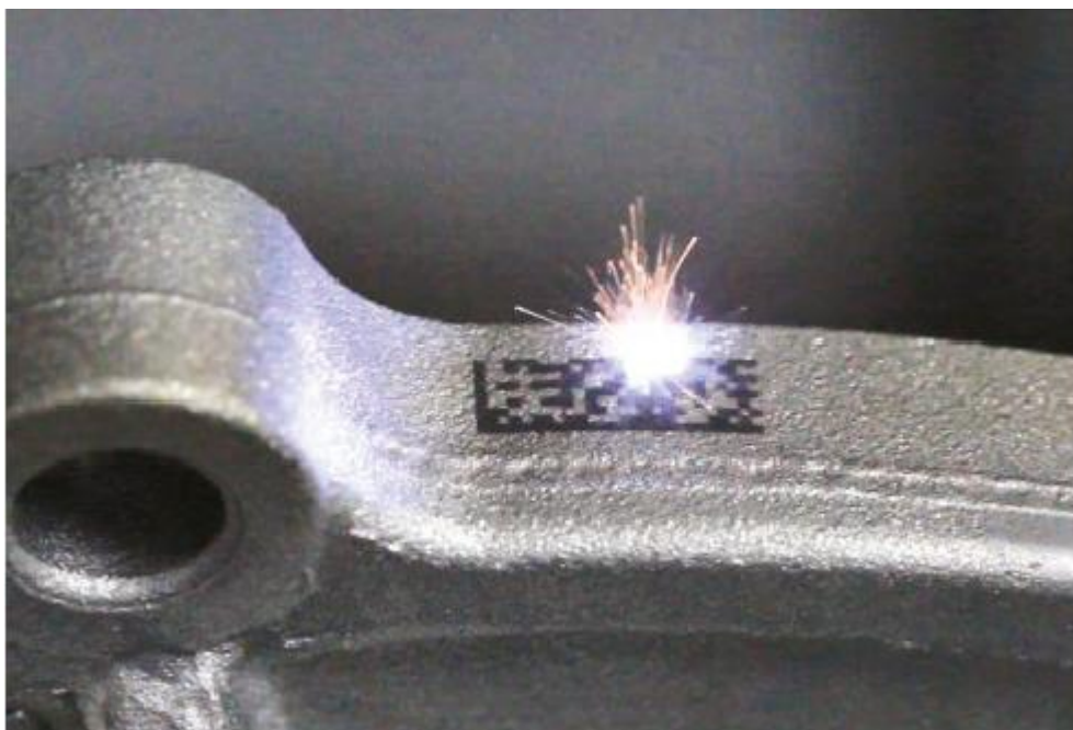
Obrázek 18: Značení DMC kódu na hliníkový odlitek [17]
