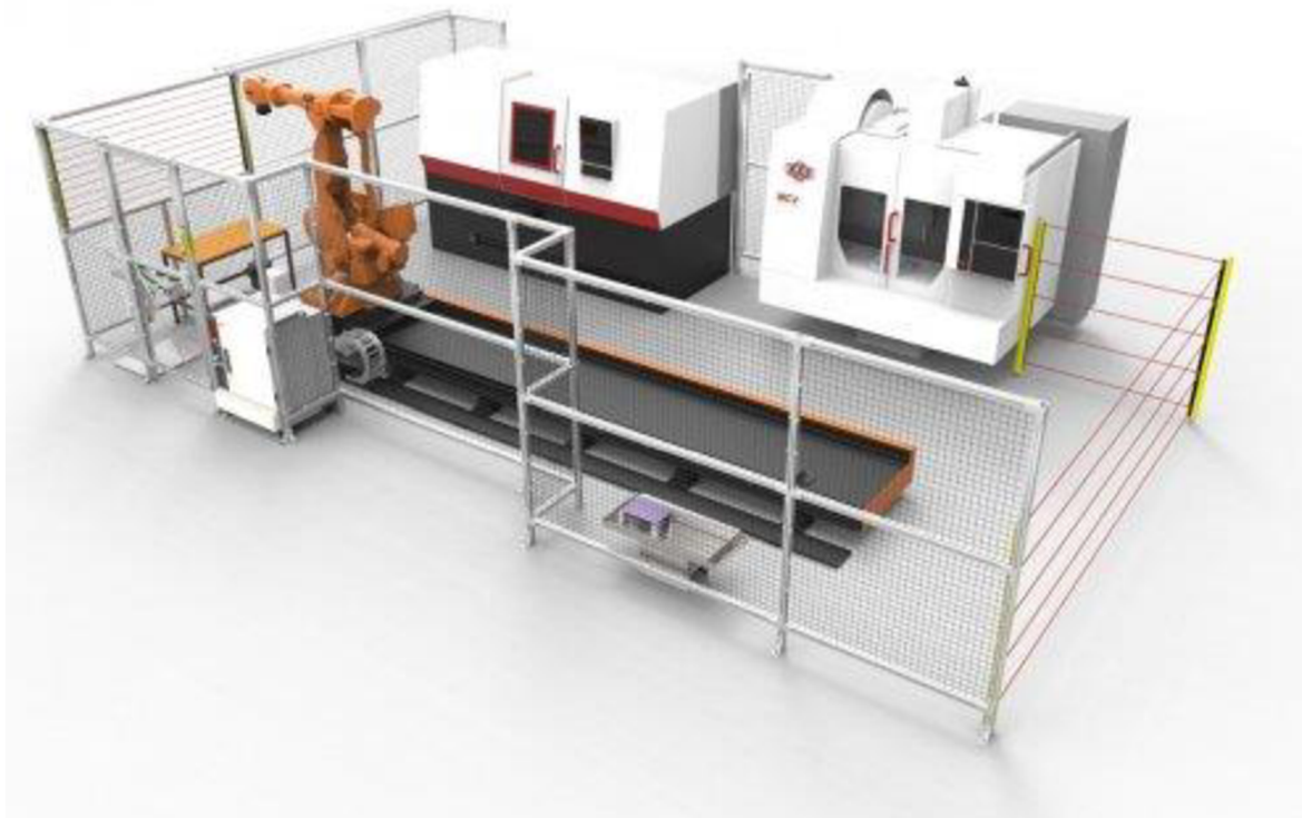
Obrázek 26: Digitální dvojče výrobní buňky vytvořené na ÚVSSR [26]
