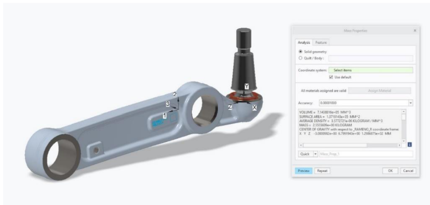
Obrázek 37: Výpočet váhy a těžiště ramene [Zdroj: vlastní]
