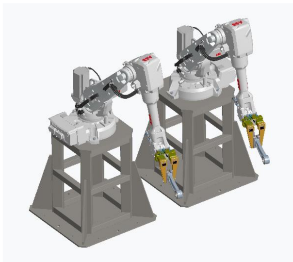
Obrázek 48: Roboty s podstavci v pozici odebrání ramen [Zdroj: vlastní]
