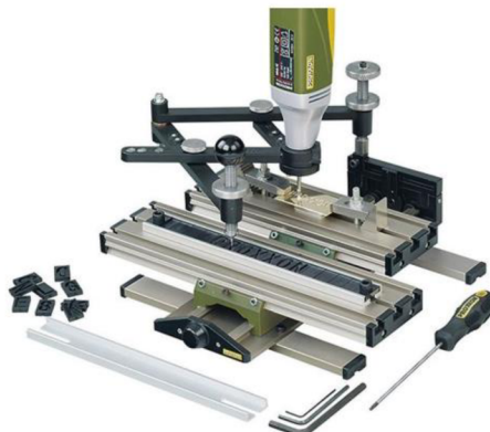
Obrázek 10: Gravírovací zařízení Proxxon – využití pantografu [11]
