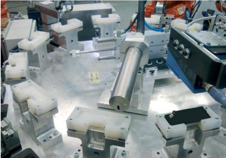
Obrázek 21: Značení komponent technologií InkJet na otočném stole [19]
