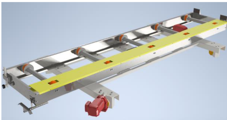
Obr. 19 3D model konštrukcie otočného stola
