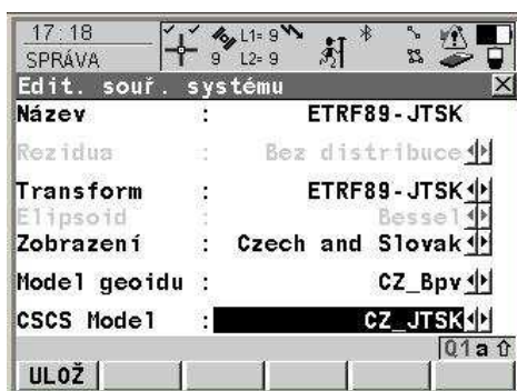
Obr. 4.10 – Zavedený transformační klíč v aparatuře
