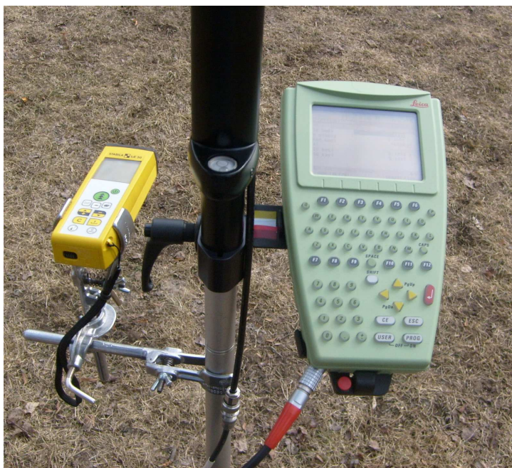
Obr. 5.03 – Upevnění ručního dálkoměru na aparaturu Leica
