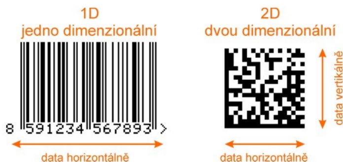
Obr. 1.7 Rozdíl mezi lineárním a maticovým kódem
