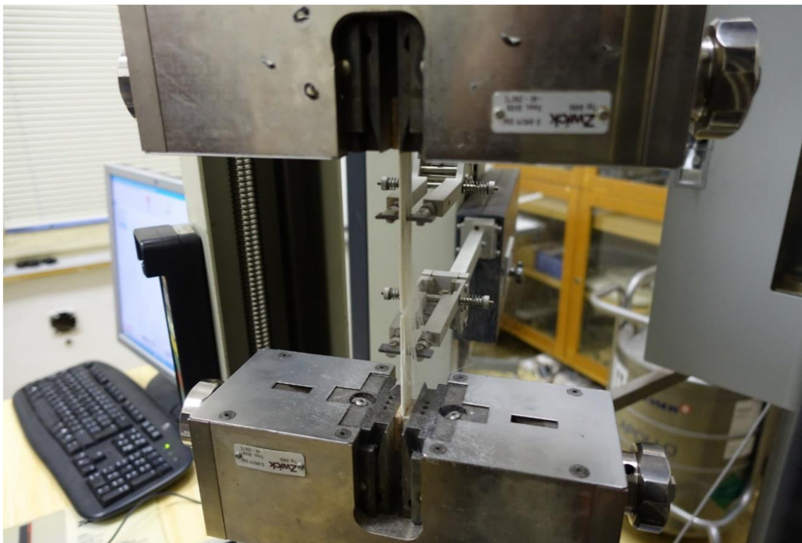
Obrázok 3.1: Statická skúška v ťahu kompozitu s povrchovou vrstvou
