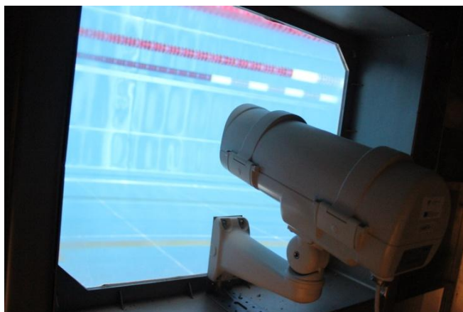
Obrázek 34. Podvodní kamera v AC BALUO (pro natočení z bočního pohledu).
