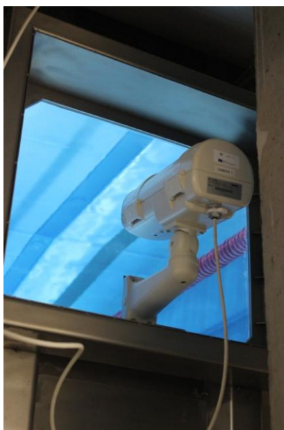
Obrázek 35. Podvodní kamera v AC BALUO (pro natočení ze zadního pohledu).
