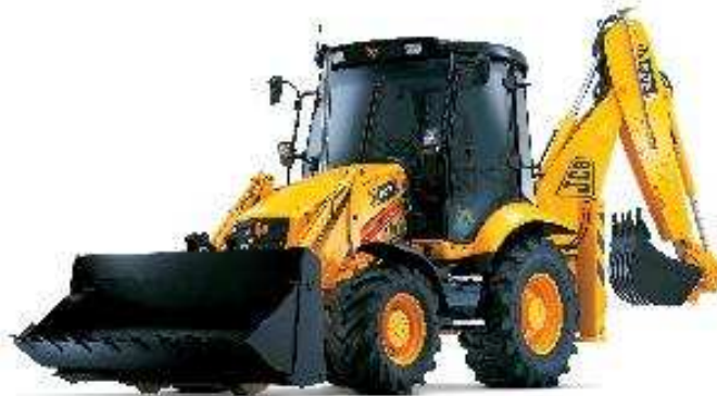
Obr. 10: Rypadlo kolové na traktorovém podvozku
