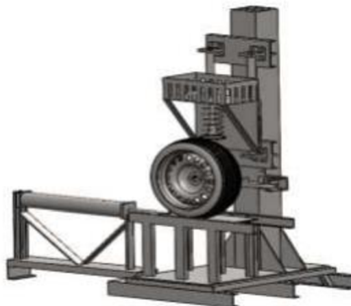
Obr. 5 zařízení se dvěma aktuátory [37]
