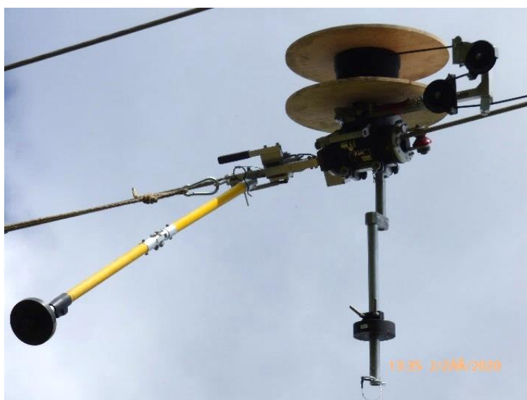
Obrázek 18: Přípravek pro ovíjení optického kabelu
