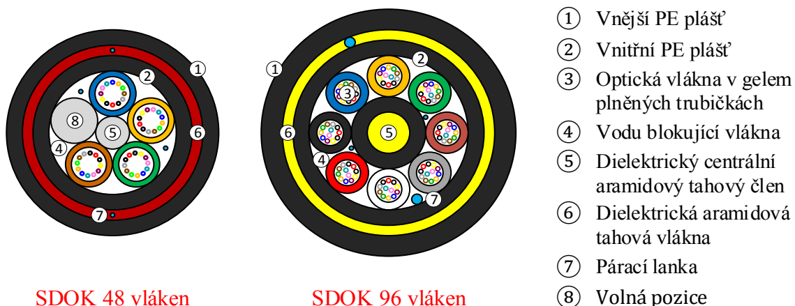
Obrázek 8: Řez SDOK (Zdroj: vlastní zpracování dle: [19])
