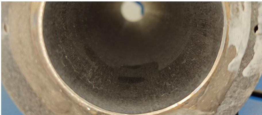
Obrázek 8-5 Detail na hrubost povrchu trubice
