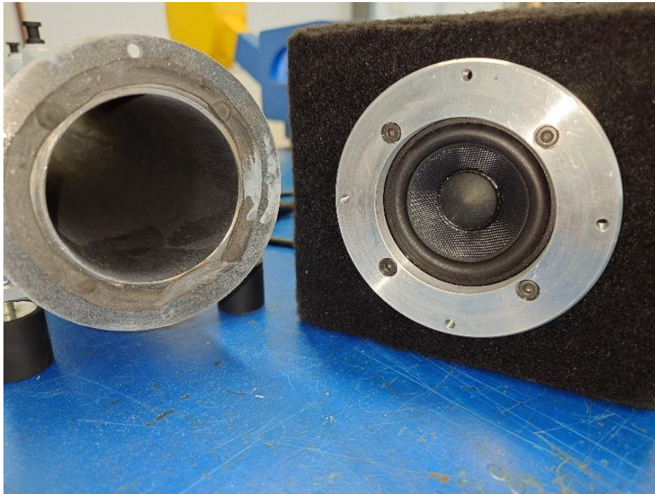
Obrázek 8-4 Pohled na uchycení příruby a reproduktoru
