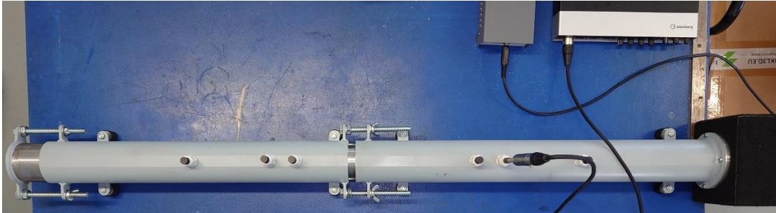
Obrázek 11-1 Trubice sestavena pro měření neprůzvučnosti
