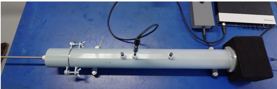
Obrázek 10-1 Uspořádání pro měření činitele zvukové pohltivosti
