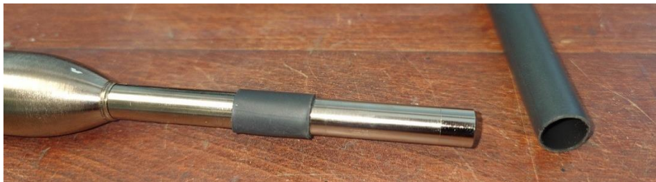
Obrázek 8-7 Systém pro konzistentní zapuštění mikrofону do trubice
