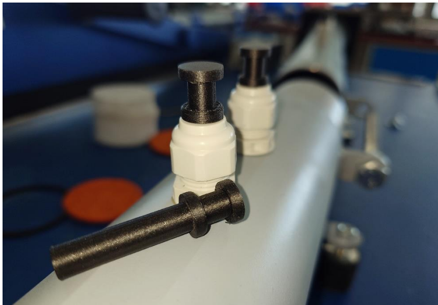
Obrázek 8-6 Detail na kabelové vývodky a zátky
