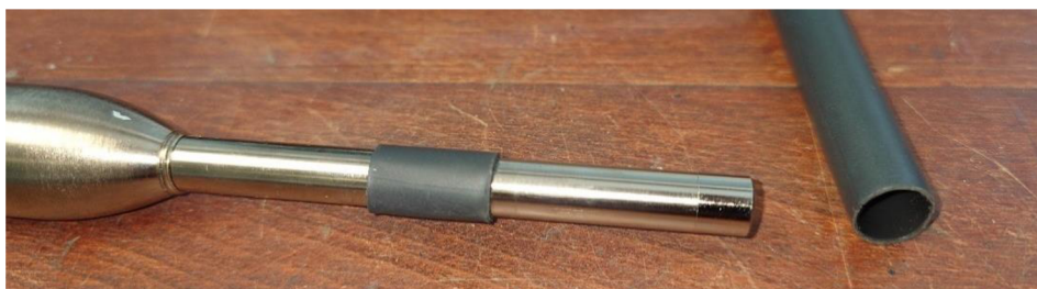
Obrázek 8-7 Systém pro konzistentní zapaštění mikrofonu do trubice
