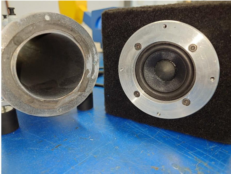
Obrázek 8-4 Pohled na uchycení příruby a reproduktoru
