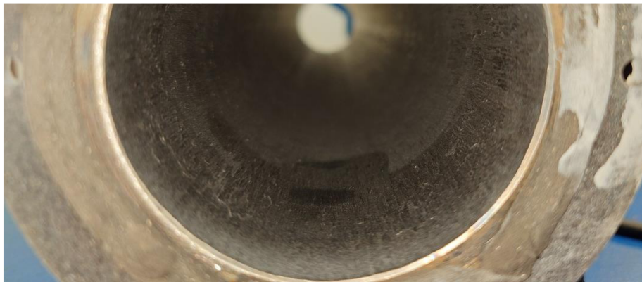
Obrázek 8-5 Detail na hrubost povrchu trubice
