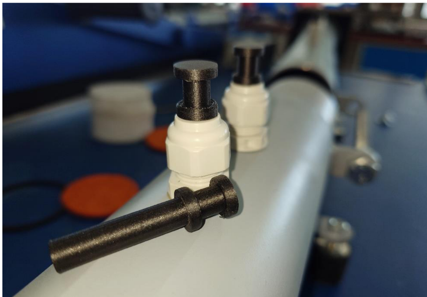
Obrázek 8-6 Detail na kabelové vývodky a zátky
