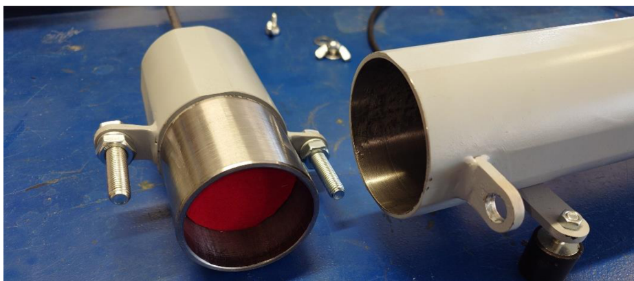
Obrázek 8-9 Náhled na pístové zakončení pro měření červené plstě
