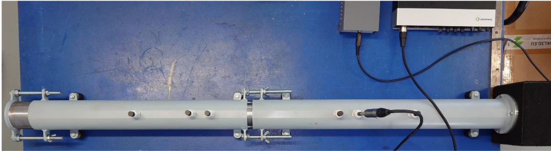
Obrázek 11-1 Trubice sestavena pro měření neprůzvučnosti
