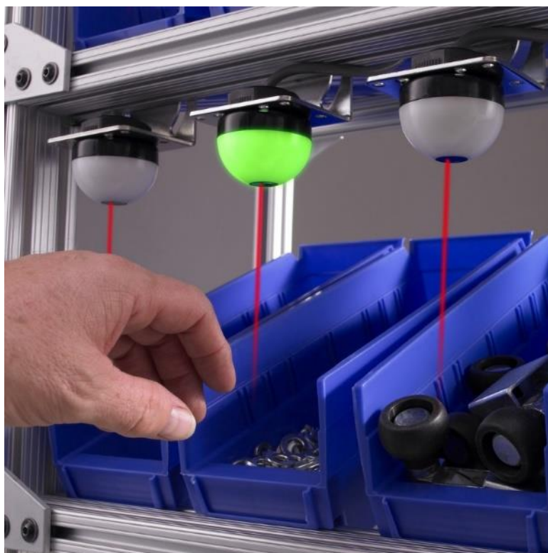
Obrázek 55: Použití systému "Pick to Light"[18]
