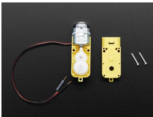
Obrázek 2 - Pohled na převodovku motoru [43]
