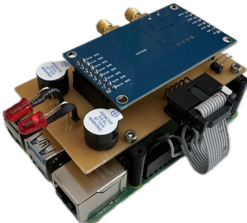
Obr. 5.6: Doska plošného spoju prepojená s platformou Raspberry Pi 4.
