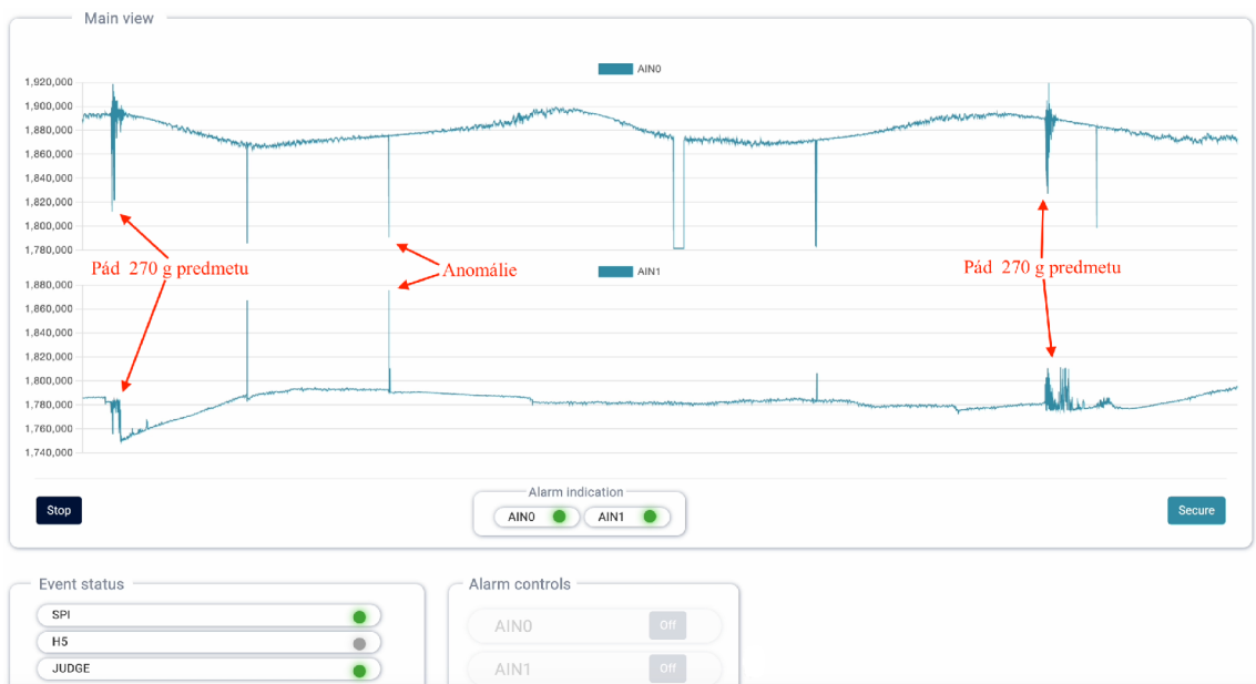
Obr. 7.10: Zobrazenie Dashboard počas priebehu testovacieho scenáru č. 3.
