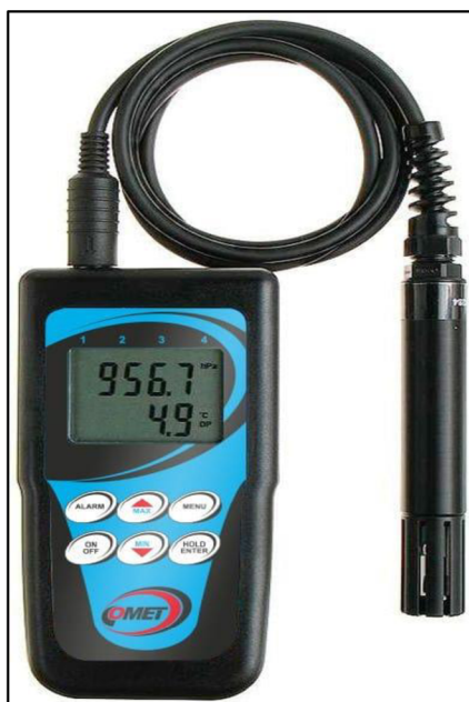
Obrázek 3.2: Termohydrobarometr Comet (Cometsystem.cz, 2021b)
