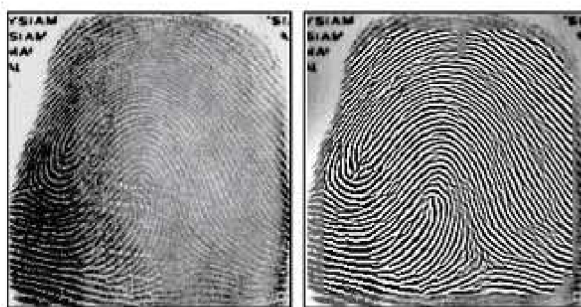
Obr. 2.5: Binarizace obrazu pomocí Gaborovy filtrace
