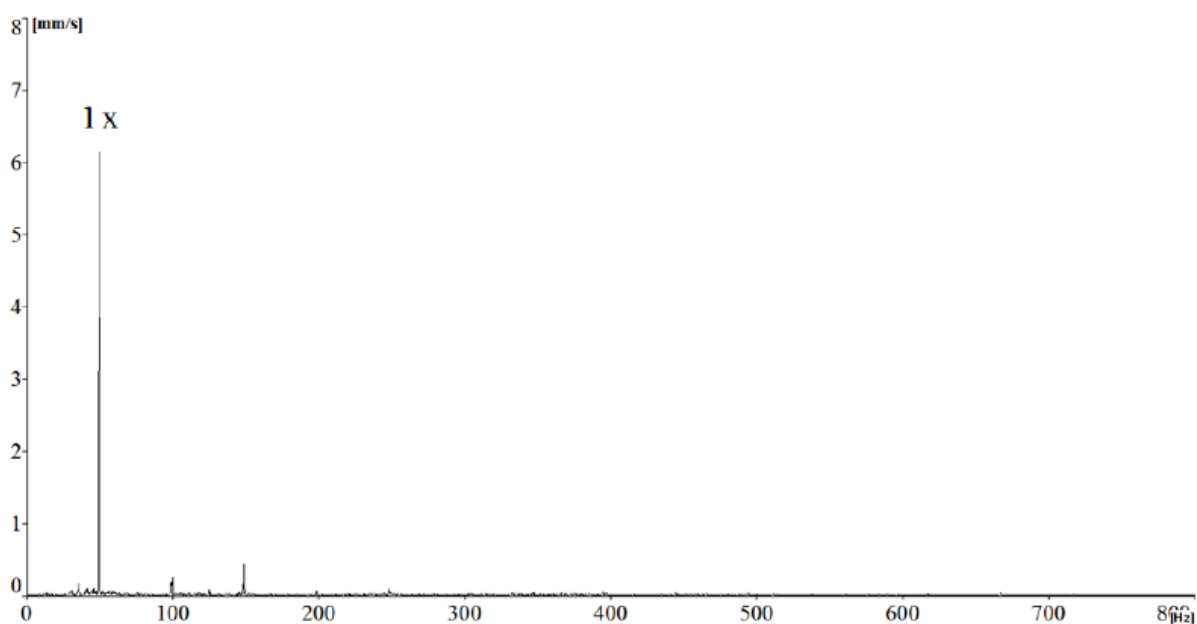
Obr. 12) Statická nebo momentová nevyváženost ve frekvenčním spektru [1]
