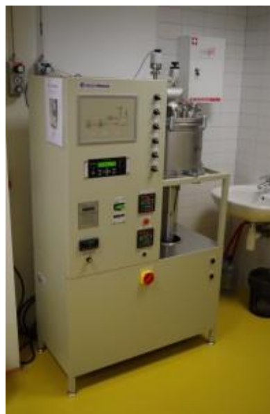
Obr. 47: Muflová pec pro žihání při atmosférickém tlaku (vlevo) a pec pro žihání ve vakuu (vpravo).
