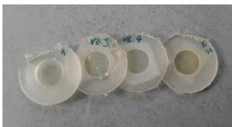
Obr. 28: Připravené vzorky aluminových membrán.
