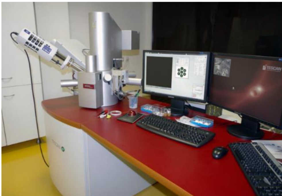
Obr. 30: Rastrovací elektronový mikroskop MIRA II/LMU s instalovaným detektorem EDX a WDX.
