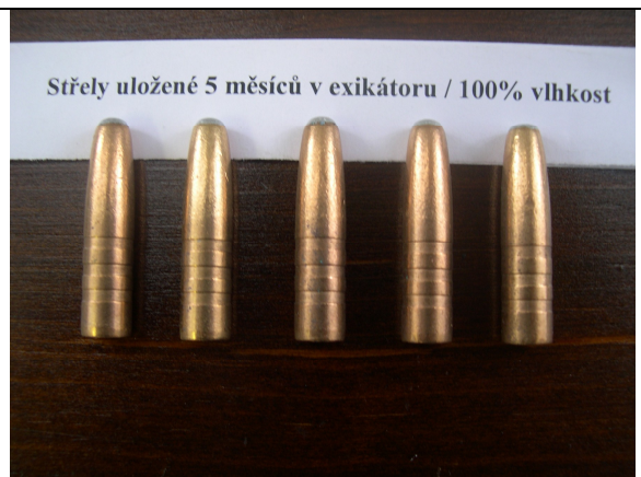
Střela eXergy – zkoušky „stárnutí materiálu“
