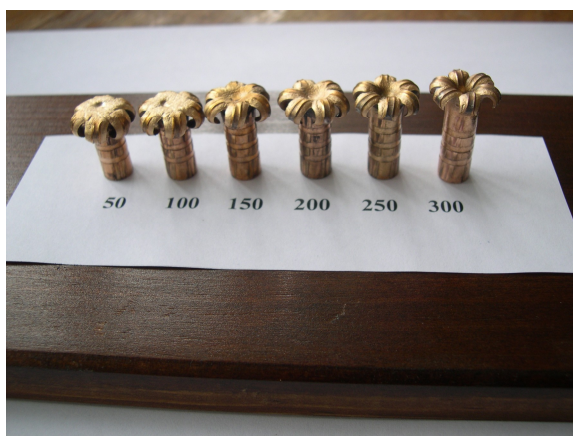
Střela eXergy – řízená deformace
