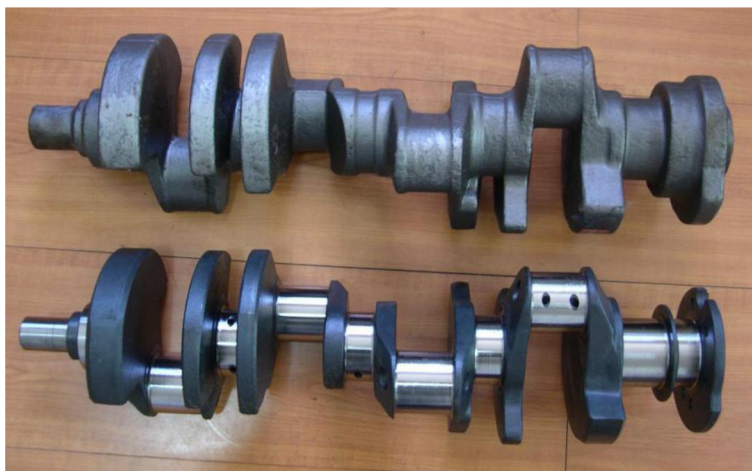
Obr. 20 Kovaná kliková hřídel [17]
