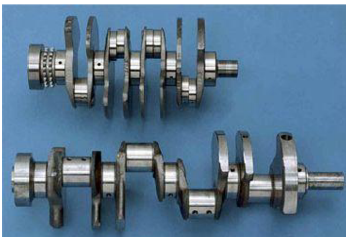
Obr. 16 Porovnání klikové hřídele W8 (vrchní) a V8 (spodní) [13]
