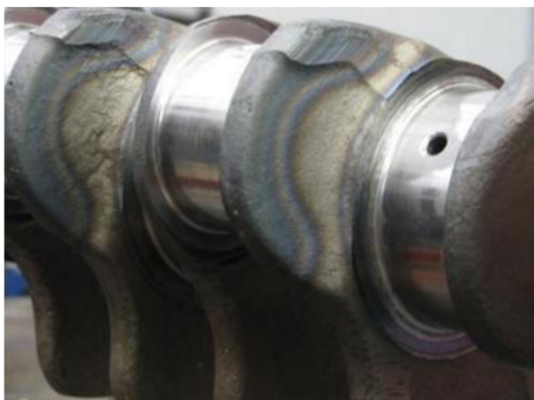
Obr. 24 Zabarvení klikové hřídele po indukčním kalení [25]
