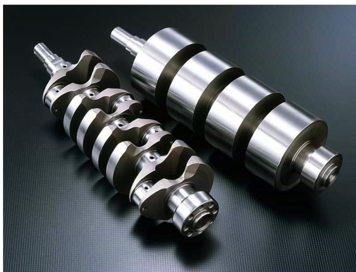
Obr. 22 Celoobrobená kliková hřídel a její polotovár [19]
