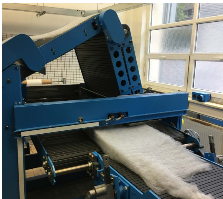
Obr. 9: Počátek vlákenné vrstvy vzniklé vertikálním příčným kladením
