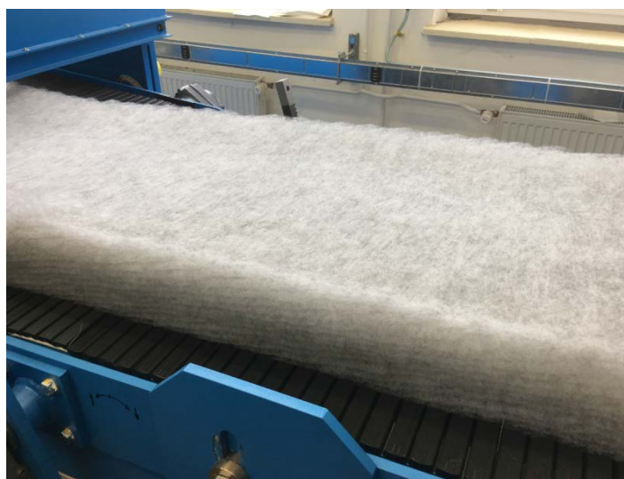
Obr. 10: Konečná příčně kladená vlákenná vrstva
