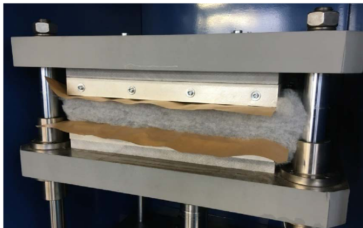
Obr. 11: Vlákněná vrstva mezi deskami etážového lisu před lisováním
