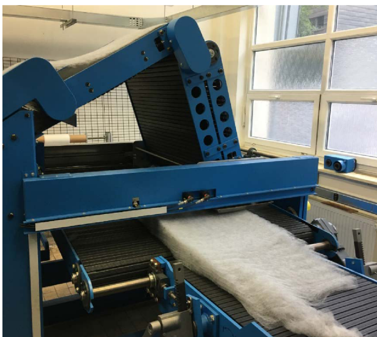
Obr. 9: Počátek vlákenné vrstvy vzniklé vertikálním příčným kladením
