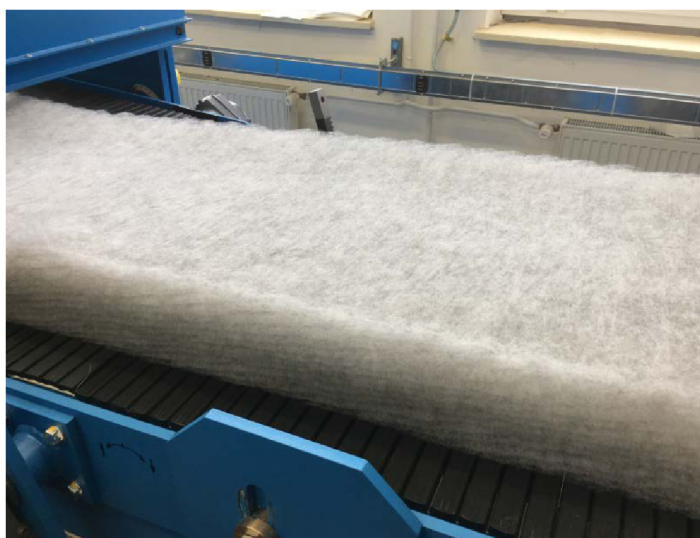
Obr. 10: Konečná příčně kladená vlákenná vrstva
