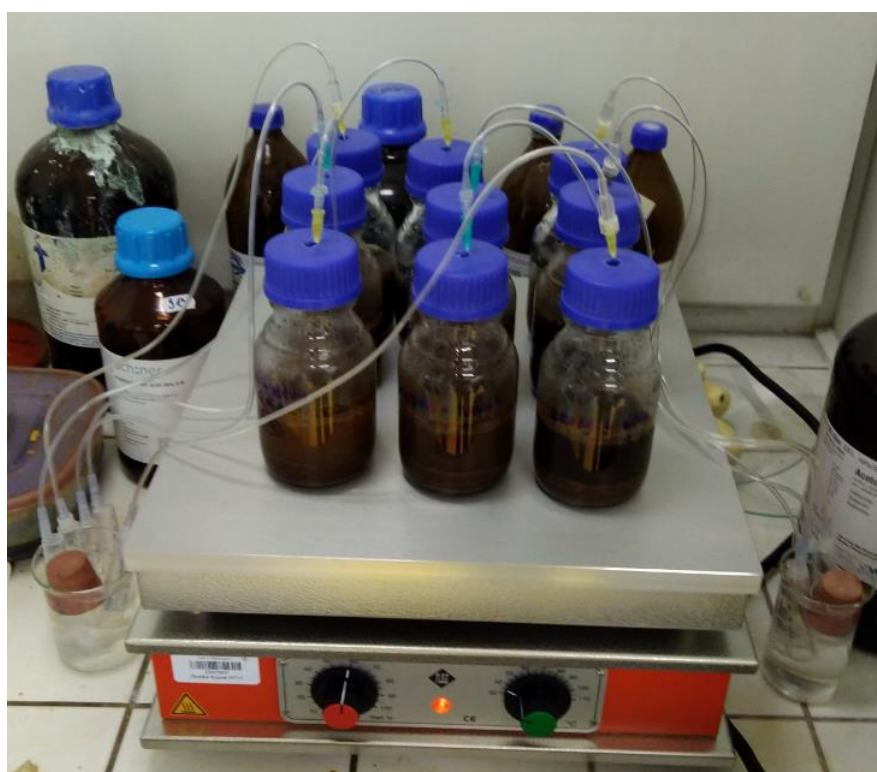
Obr. 9: Probíhající anaerobní fermentace 1.
