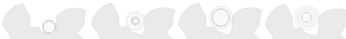
Obr. 45 Tvarové lůžko s různými velikostmi lahví (zleva: \varnothing 53,3 mm; \varnothing 61,2 mm; \varnothing 95,3 mm; \varnothing 102 mm)
