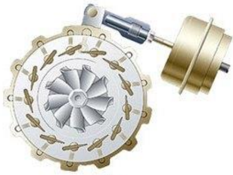
Obrázek 15 Regulace pomocí naklápěcích lopatek, nízké otáčky motoru [14]
