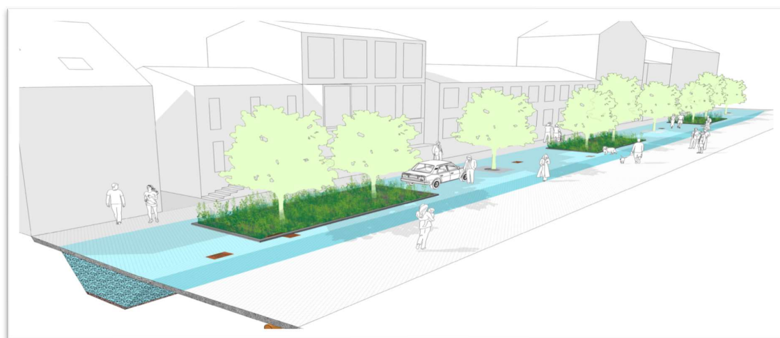
Obr. 8 Livable streets – A handbook of Bluegreengrey systems – Edge MZŠ infrastruktura. Místo vyznačené modrou barvou je prokořenitelná vrstva, která v případě potřeby může být zatopena vodou.
