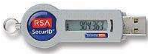
Obrázek 2: Token RSA SecurID SID800 (převzato z [7])
